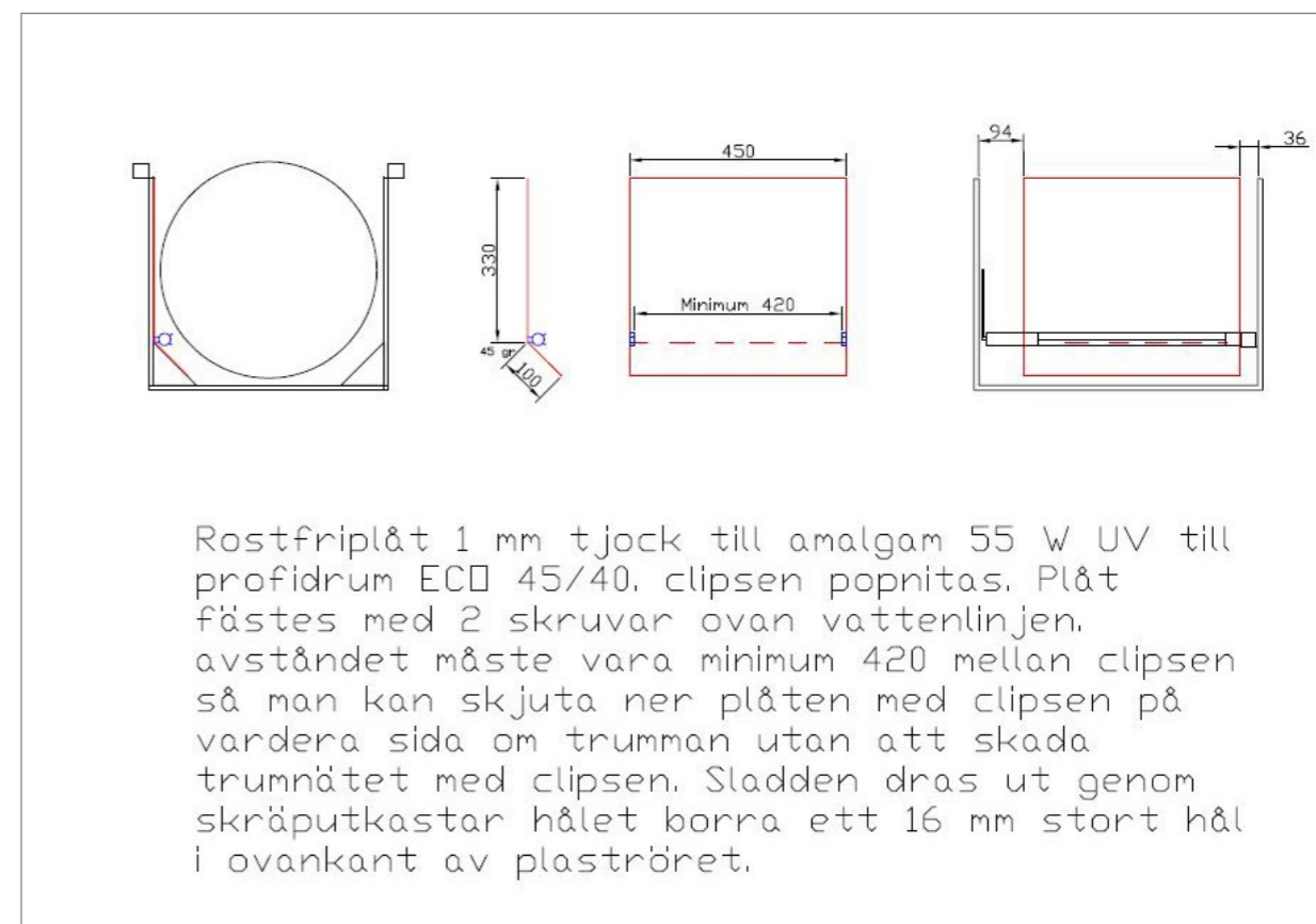
Ritning över den skyddande plåten, markerad med rött.
