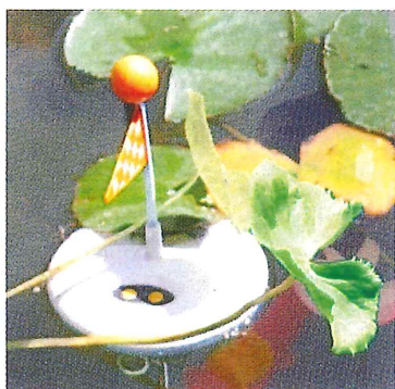
En dammtermometer som sänder aktuell temperatur till en display inne i huset
