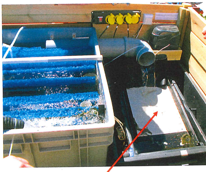
Biotech 18 filter med sil som rengörs automatiskt
